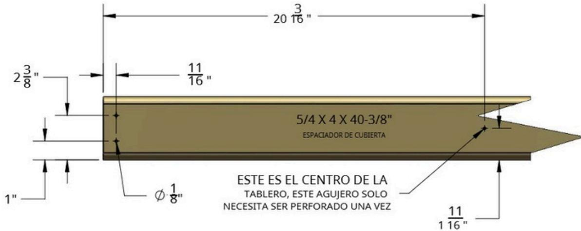
2: COLOQUE EL ESPACIADOR DE CUBIERTA DE 5/4 X 4 X 40-3/8" EN UN EXTREMO DEL FUERTE. CENTRE LA TABLA ENTRE LOS POSTES DE LAS ESQUINAS Y FÍJELA CON TORNILLOS PARA MADERA DE 2" A TRAVÉS DE LOS ORIFICIOS PRE-TALADRADOS Y EN EL SOPORTE DE CUBIERTA DEBAJO. NOTA: LA PARTE SUPERIOR DE LA CABEZA DEL TORNILLO DEBE QUEDAR A RAS DE LA PARTE SUPERIOR DEL ESPACIADOR DE CUBIERTA.
